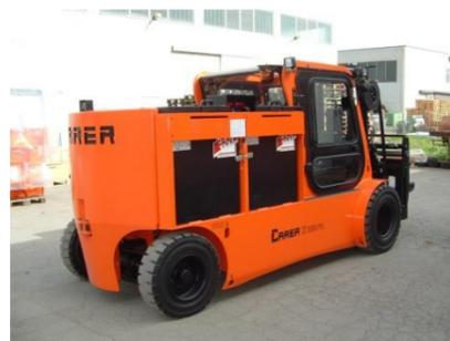
Lenkachse ausgestattet, die einen sehr starken Lenkeinschlag ermöglicht in Kombination mit einer weichen, sehr präzisen Lenkung, dank separater Lenkpumpe.
